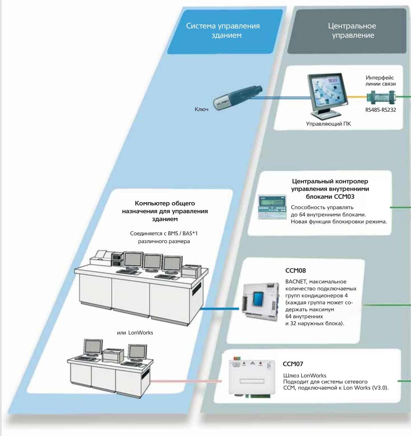
\*1. BMS / BAS: Система управления зданием / Система автоматизации здания
