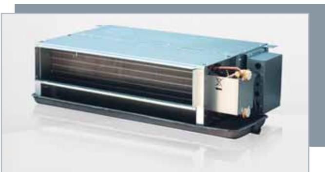
Устанавливаются за подвесным потолком и не нарушают интерьер помещений. Особенность канальных фанкойлов заключается в том, что они могут подсоединяться к общей вентиляционной системе здания и, таким образом, не только охлаждают или обогревают помещение, но еще и подмешивают свежий воздух из приточной установки. Различаются по производительности и статическому давлению.
