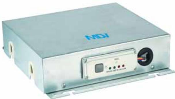
Комплект автоматики для фанкойлов серий MDKT, MDKF. Позволяют реализовать управление с центрального контроллера ССМ03, и использовать все возможности диспетчеризации, используя шлюзы протоколов BACNet и LonWorks. Возможно применение программ APOGEE от Siemens, Andover от Schneider, Alerton от Honeywell и другие.
